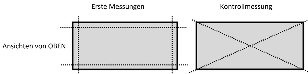
Die Luftblase in der Wasserwaage muss bei allen Messungen genau in der Mitte sein.
